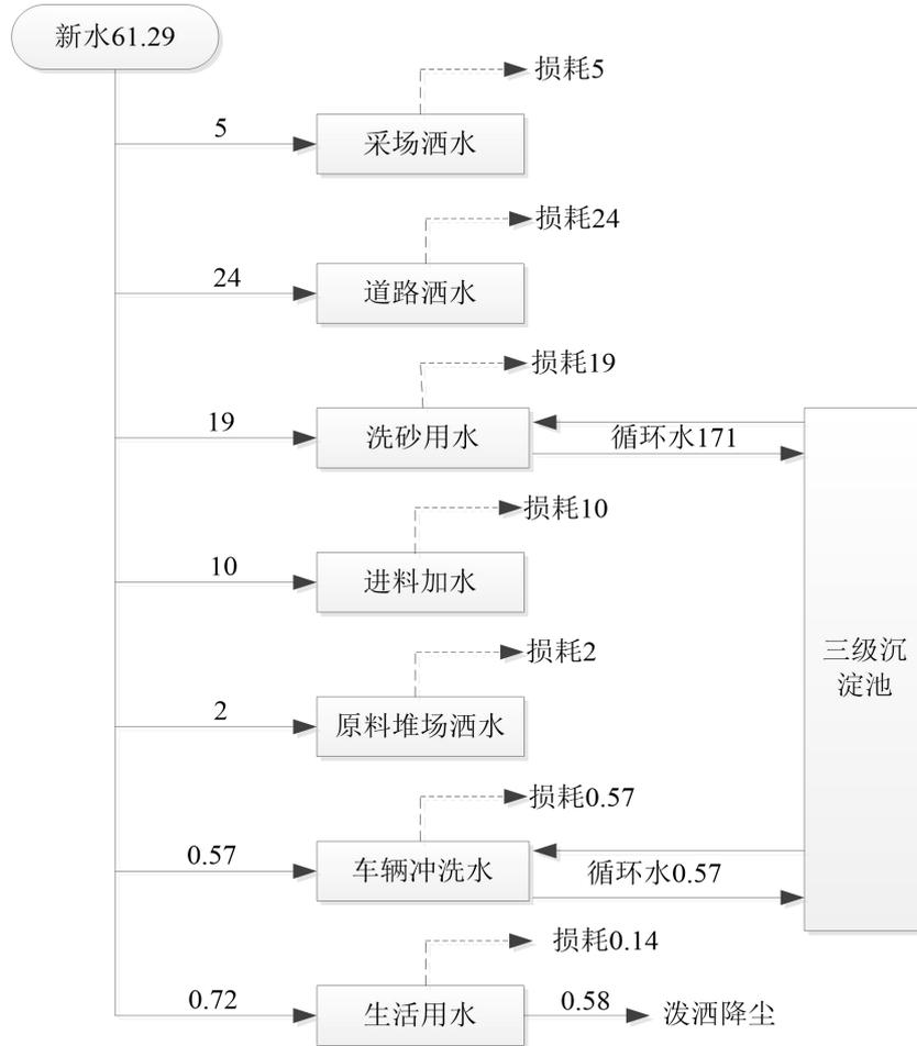
图 2.5-1 项目给排水平衡图 单位：m<sup>3</sup>/d
